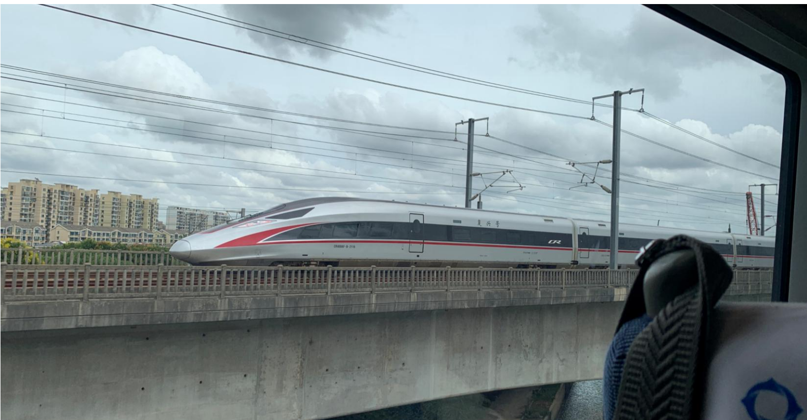
Hochgeschwindigkeitszug „Fuxing“ CR400 auf der Fahrt von Peking nach Shanghai. Der Zug ist für eine V(max) von 400 km/h zugelassen
